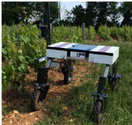
*Рисунок 11.39 – Робот для обрезки виноградной лозы фирмы Wall-Ye*
