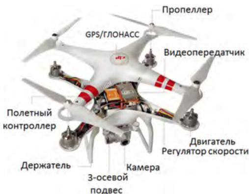
Рисунок 2.3 – Устройство беспилотника вертолетного типа
