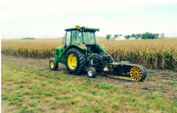
*Рисунок 11.41 – Система для взятия почвенных образцов*
