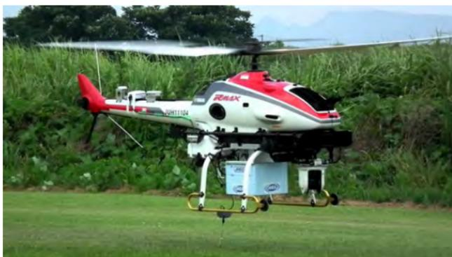
*Рисунок 2.57 – Беспилотный вертолет Yamaha R-MAX для опрыскивания виноградников*
