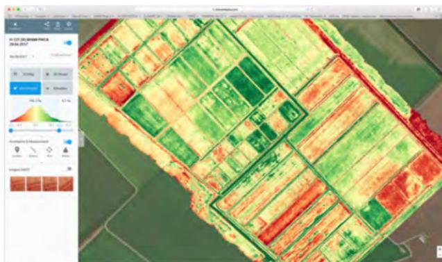
*Рисунок 2.37 – Вегетационный индекс растительного покрова посевных площадей рисовых чеков ВНИИ риса (по материалам аэрофотосъемки RGB и NIR, начало июля 2017 г., С. И. Скубиев)*
