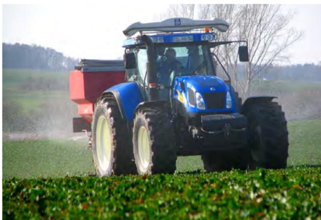
Рисунок 2.9 – Трактор с установленным на крыше Yara-N-сенсором
