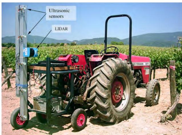
*Рисунок 9.1 – Сенсорная система лидар, установленная на тракторе*
