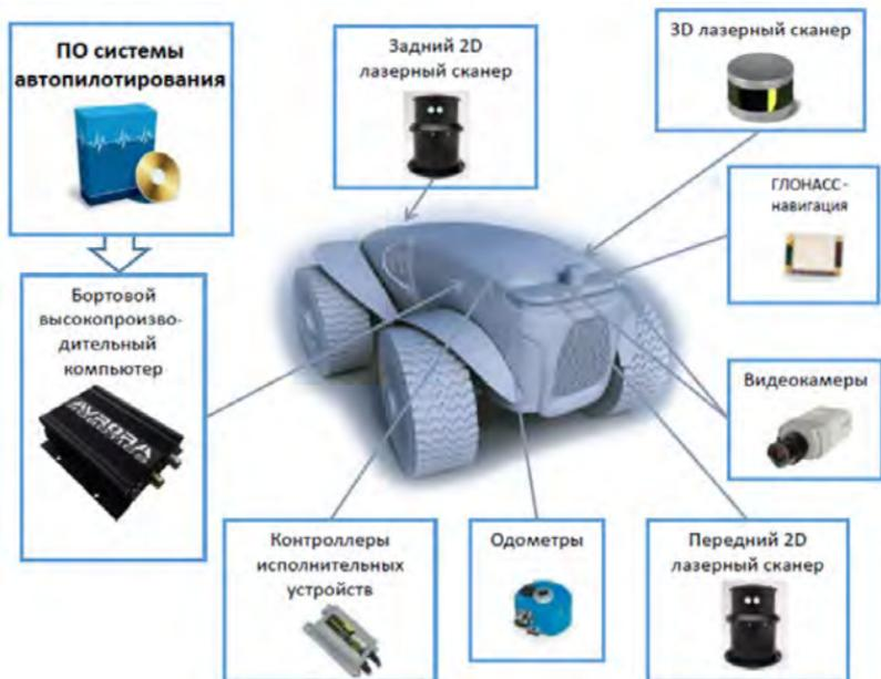
Рисунок 11.13 – Схема расположения оборудования
