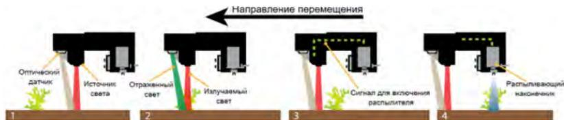
Рисунок 5.38 – Принцип работы системы WeedSeeker
