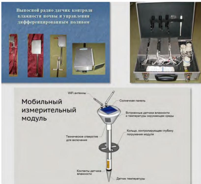
Рисунок 5.23 – Состав комплекта оборудования
