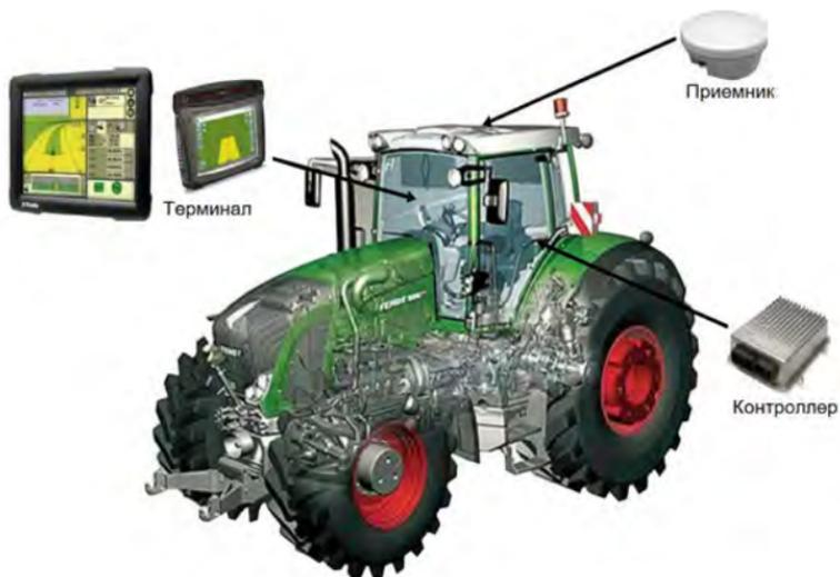
Рисунок 4.9 – Комплект оборудования для параллельного вождения на тракторе
