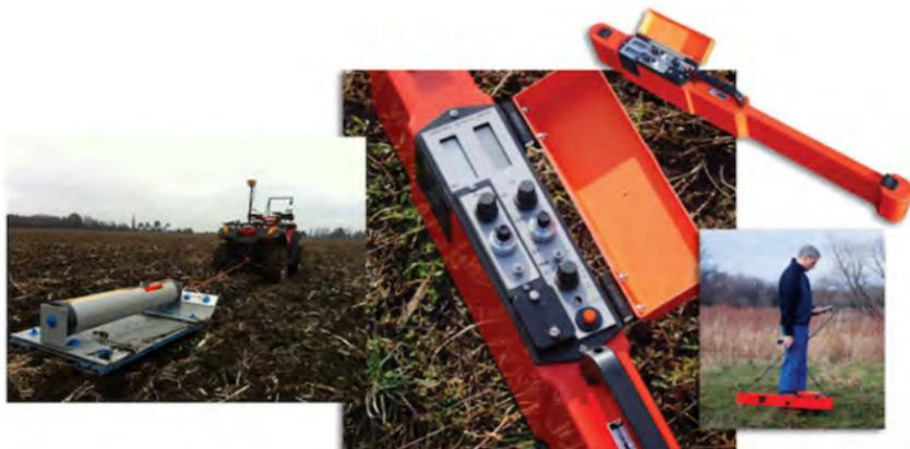
*Рисунок 2.6 – Датчик отображения проводимости почвы EM-38-MK2*
