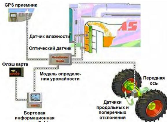
Рисунок 7.9 – Система картирования урожайности комбайна Claas
