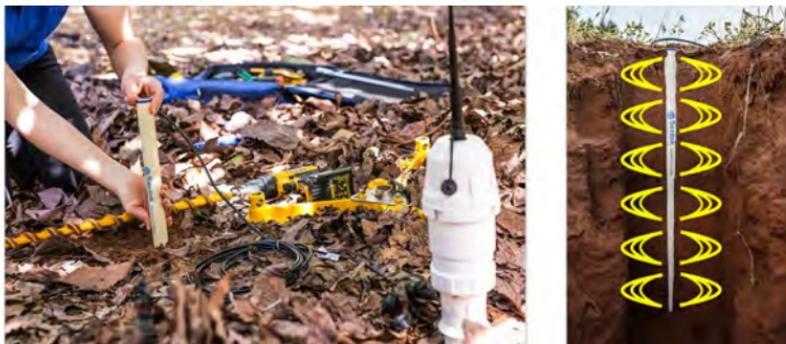
Рисунок 6.3 – Датчик Triscan для измерения электрической емкости почвы
