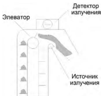
*Рисунок 6.13 – Схема косвенного определения импульса прохода зерна в зерновом элеваторе измерением интенсивности гамма-лучей радиоактивного элемента в радиодетекторе*
