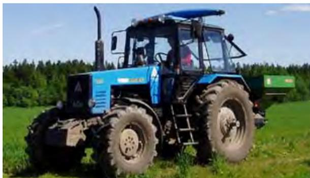
*Рисунок 2.8 – Трактор МТЗ 1221 с распределителем минеральных удобрений Amazone ZA-M 1500 и Hydro-N-сенсором на крыше (Агрофизический НИИ)*
