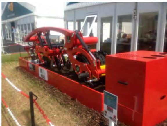
*Рисунок 5.3 – Стенд секции культиватора для дифференцированной обработки почвы*
