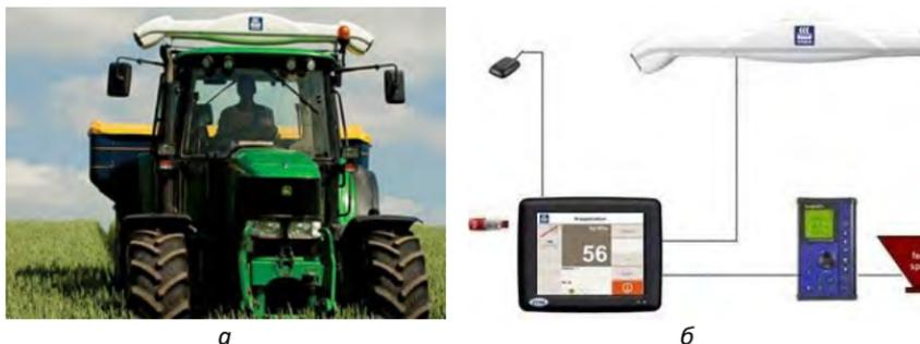
*Рисунок 6.8 – Система YARA N-датчик для определения доз азота: а – установленная на тракторе; б – элементы системы.*
