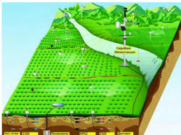
Рисунок 6.4 – Система Cairros беспроводного мониторинга влажности почвы и погоды
