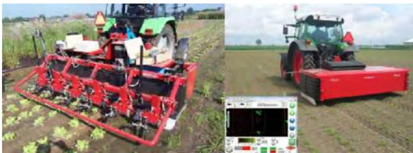
*Рисунок 11.25 – Сенсорная технология, используемая на машинах для селективного контроля сорняков и фенотипирования*
