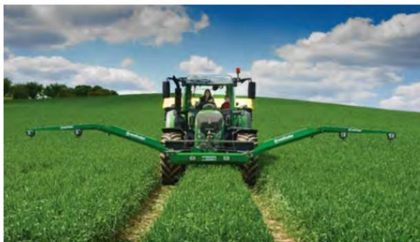
*Рисунок 2.7 – Трактор с сенсором GreenSeeker*
