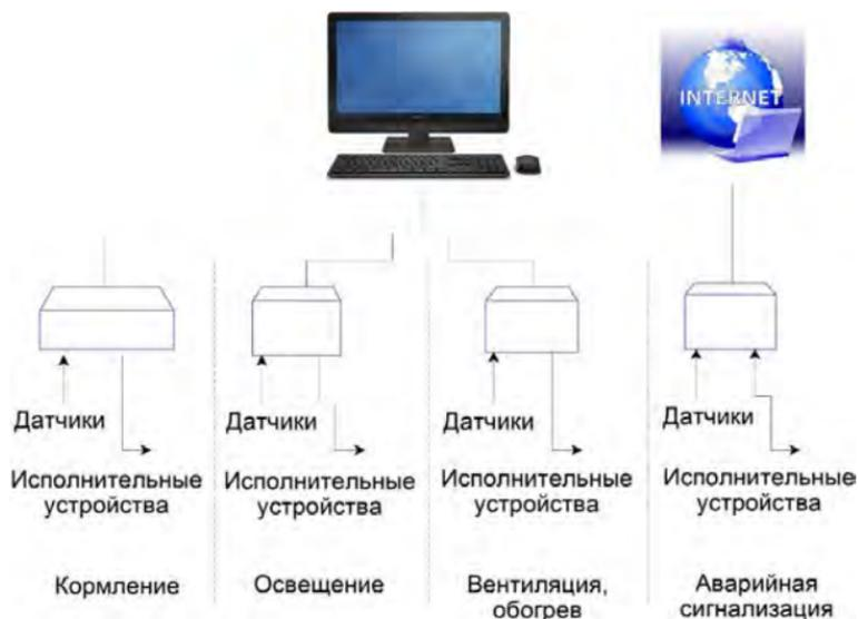
*Рисунок 12.24 – Схема связи процессоров между собой и с персональным компьютером с помощью ISOBUS-интерфейсов в единую коммуникативную систему*
