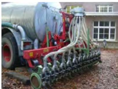
*Рисунок 5.10 – Машина для дифференцированного внесения жидких удобрений*
