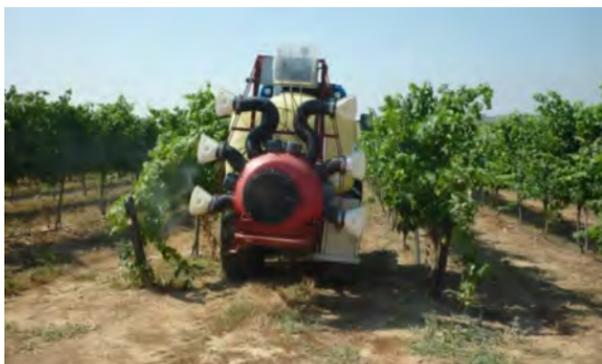
*Рисунок 9.4 – Дифференцированное опрыскивание с использованием полученных данных с помощью лидара*
