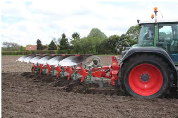
*Рисунок 5.4 – Навесной оборотный плуг Kverneland 2500 i-Plough*
