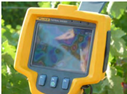
*Рисунок 9.7 – Ручной тепловой датчик изображений*
