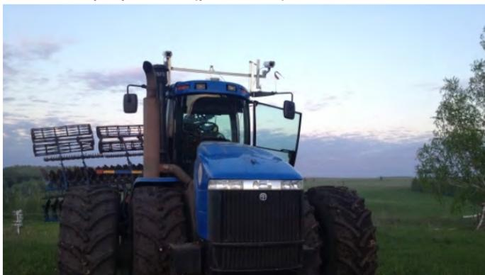
*Рисунок 11.17 – Трактор с системой компьютерного зрения Cognitive Technologies*
