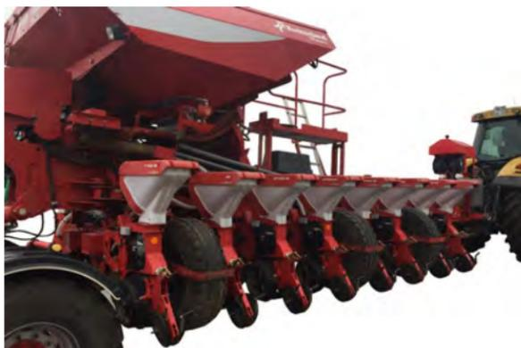
*Рисунок 5.15 – Сеялка Kverneland Optima TF Maxi для дифференцированного посева пропашных культур*
