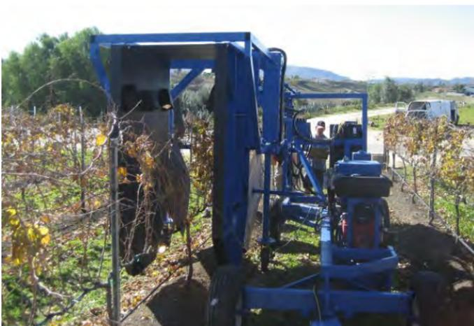
*Рисунок 11.37 – Робот для обрезки виноградной лозы фирмы Vision Robotics Corporation*
