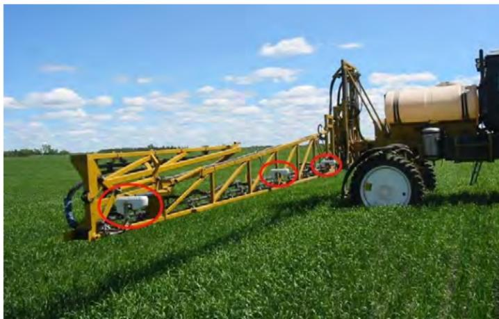
*Рисунок 6.10 – Датчики GreenSeeker RT200*
