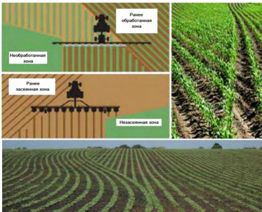
Рисунок 15.2 – Схемы секционного контроля посева и опрыскивания
