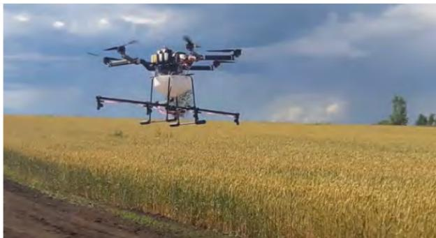
Рисунок 2.24 – Дифференцированное опрыскивание посевов
