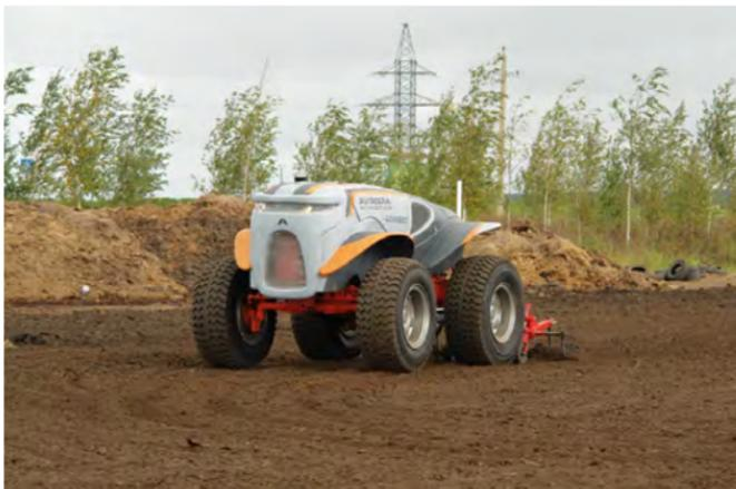
*Рисунок 11.11 – Колесный беспилотный роботрактор Агробот*
