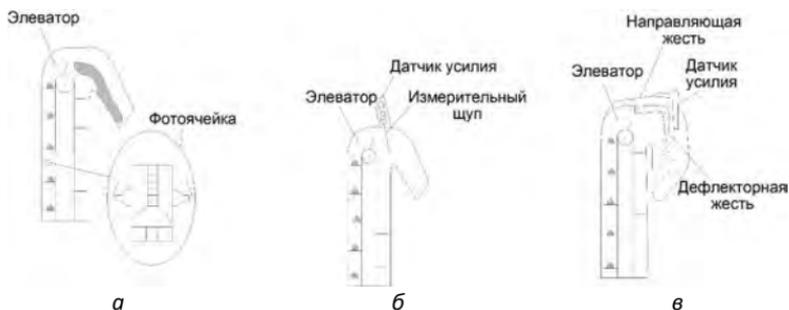
Рисунок 6.12 – Схема измерения объема проходящего зерна в элеваторе:
