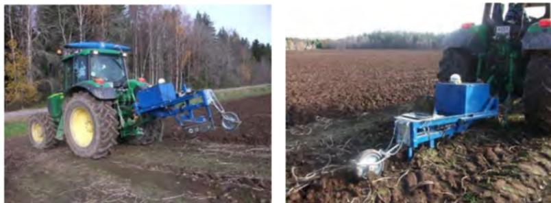
*Рисунок 3.15 – Мобильный комплекс для измерения агрофизических свойств почвы*
