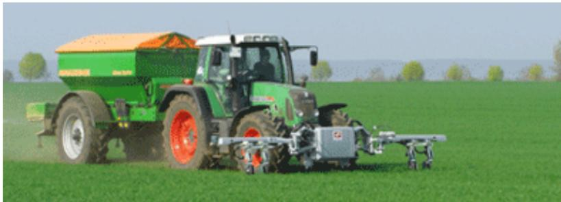
*Рисунок 6.9 – Система MiniVeg N для определения доз азота*
